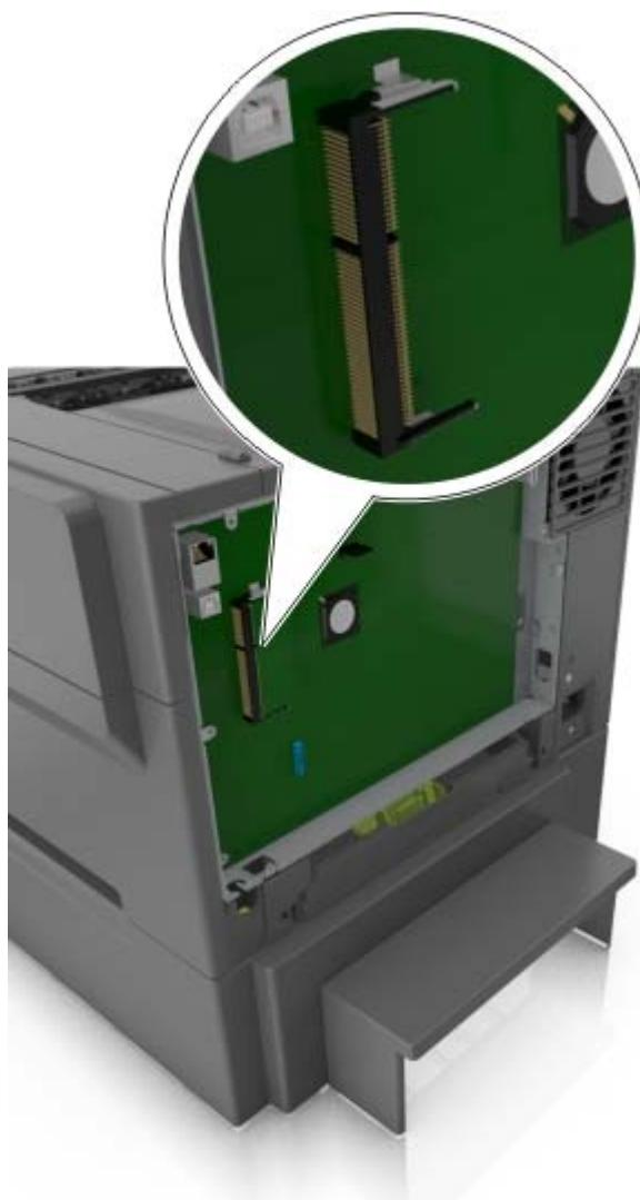
**警告—可能的损坏：**控制器板电子组件容易被静电损坏。在接触任何控制器电子组件或连接器之前请先触摸一下打印机上的金属表面。
