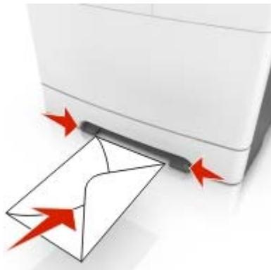
**2** 将纸张送入手动进纸器时，只让它的引导边可以接触到纸张导片。
