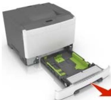
**2** 压住宽度导片凸柱，然后将它滑动到与您加载的纸张相符的正确位置上。
